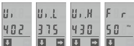
Der Ausgang des PVSB Schaltnetzteils wird kontinuierlich strom- und spannungsüberwacht. Auf dem Display können wichtige Informationen direkt abgelesen werden. Mögliche Störungen einer Anlage werden durch die integrierte Kontrolleinheit frühzeitig erkannt, gespeichert und signalisiert. Das PVSL Schaltnetzteil ist zusätzlich zu der PVSB Ausführung mit einer integrierten Netzeingangsüberwachung ausgestattet.
