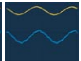
Stromverlauf am Frequenzumrichter mit Harmonic Filter HFM-FB
