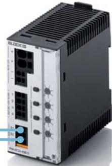
Die Schutzschalter bieten im Verbund mit einer übergeordneten Steuerung die Möglichkeit, über je einen digitalen Ein- und Ausgang jeden beliebigen Ausgangskanal aktiv ein- oder auch auszuschalten, ausgelöste Stromkreise wieder zurückzusetzen sowie zeitgleich die aktuellen Betriebs- und Fehlerzustände zu senden.
