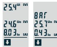
❷ Par le biais de l'écran: L'écran affiche en permanence tous les courants et tensions. Les paramètres importants peuvent être facilement réglés à l'aide des touches de l'appareil. La mémoire des erreurs intégrée permet d'effectuer soi-même un diagnostic sur l'appareil.
